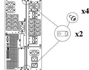
**3** Присоедините кронштейн к верхней части ИБП и обходной панели электропитания.
