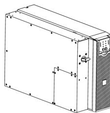
**2** Отвинтите и снимите верхнюю крышку ИБП.
