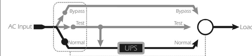
Примечание: в режимах проверки (Test) и обхода (Bypass) характеристики электропитания, потребляемого подсоединенными устройствами, не нормализуются в ИБП. При использовании этих режимов условия «Полиса защиты оборудования» недействительны.
