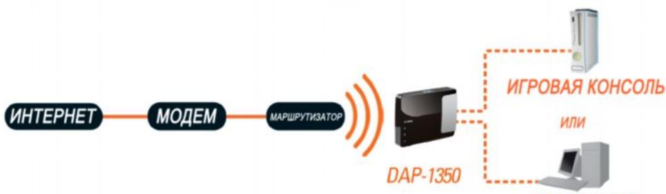
Подключите устройства с Ethernet-адаптером (такие как компьютер или Xbox 360®) к Wi-Fi сети
